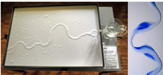
Снимка от експеримент с течения на вода, доказващи формите на меандър. Особено видимо е, когато водната струя се оцвети с мастило https://stroemungsinstitut.de
